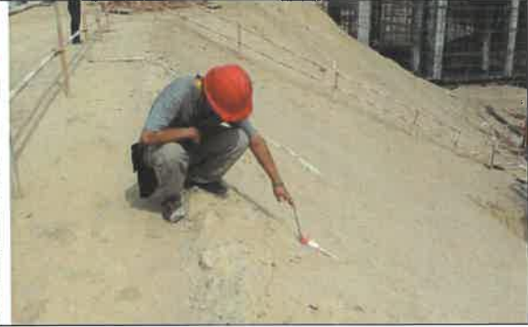
22 主体工程施工坡面风蚀监测
